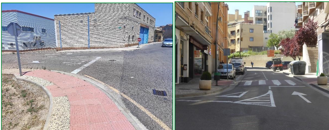
Imagen 7. Falta de continuidad en el itinerario por falta de paso de peatones (izq.) y continuidad en el itinerario (dcha.)
